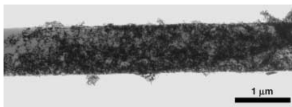
Abbildung 12. TEM-Bild eines Röhrchens mit einer Kern-Schale-Morphologie, das durch konsekutive Benetzungsschritte hergestellt wurde. Die äußere Schale ist ein Netzwerk aus Pd-Kristallen, der innere Kern besteht aus PS.
